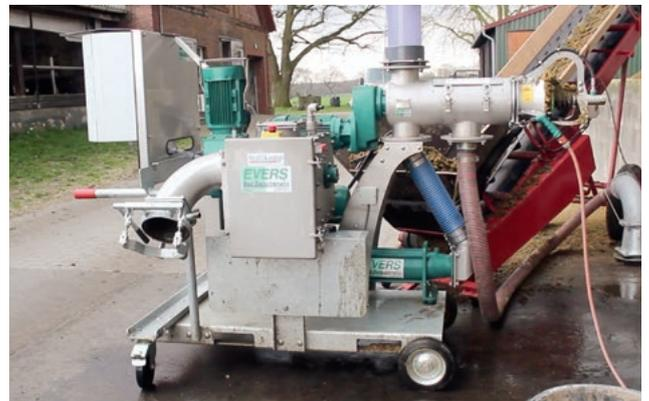
ComPress mit integriertem Schneidfilter zum Schutz der Pump- und Anlagentechnik produziert Einstreu für den Kuhbetrieb. | ComPress with integrated cutting system to protect pump and other technology produces organic bedding material for cow farming.
