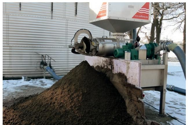
PSS 4-550 separiert mit ausgefahren Stützen und entlastet das Güllelager.
