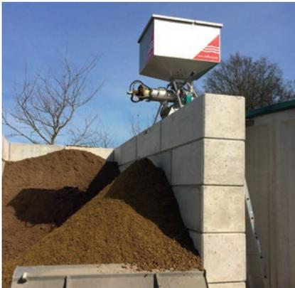
Rohgülle von ca. 6,5 % TS wird auf ca. 20 % TS Gehalt abgepresst und schafft ca. 7 m<sup>3</sup> pro Stunde.
