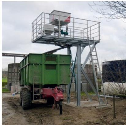
Dieser PSS 2.2-400 mit Vorlagebehälter steht auf einem Schweinemastbetrieb mit ca. 5% TS in der Ausgangsgülle. Der Kipphanhänger ist nach ca. 1,5 Tagen mit dem Separationsmaterial gefüllt.
